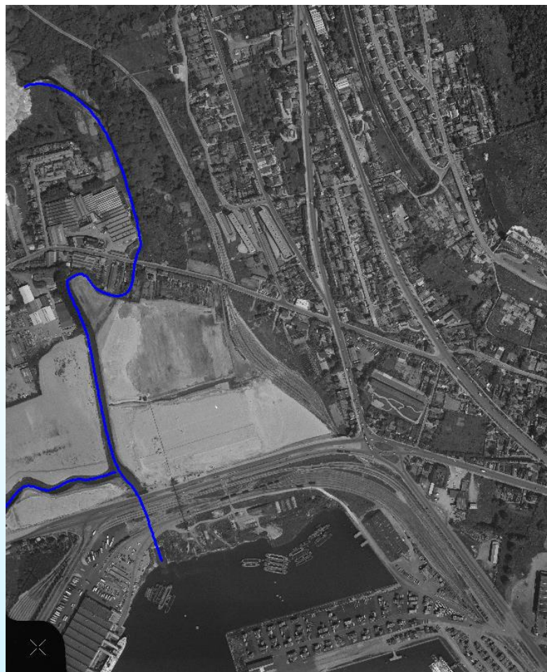
1965 : Fin des remblaiements et une linéarisation du Cailly
